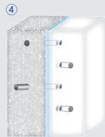
④ 隣接削孔から薬液注入
